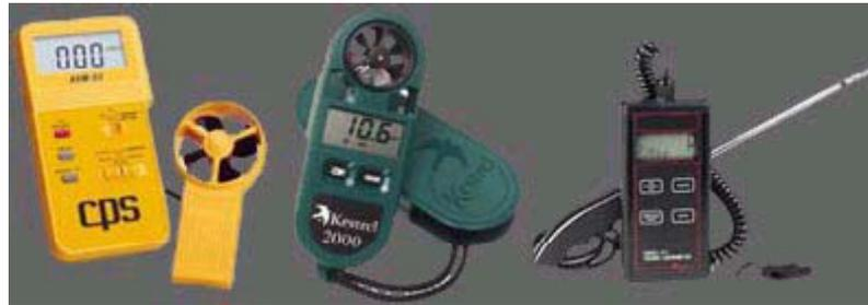
Figura 2-13 *Distintos tipos de anemómetro* (Fuente: Rosales 2007)
