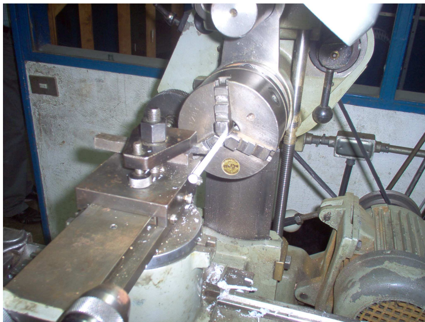
Anexo 13 Construcción de la funda de la termocupla
