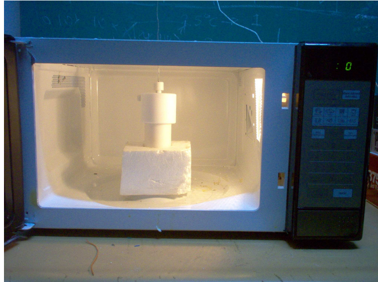
Anexo 18 Reactor dentro de la cavidad del microondas
