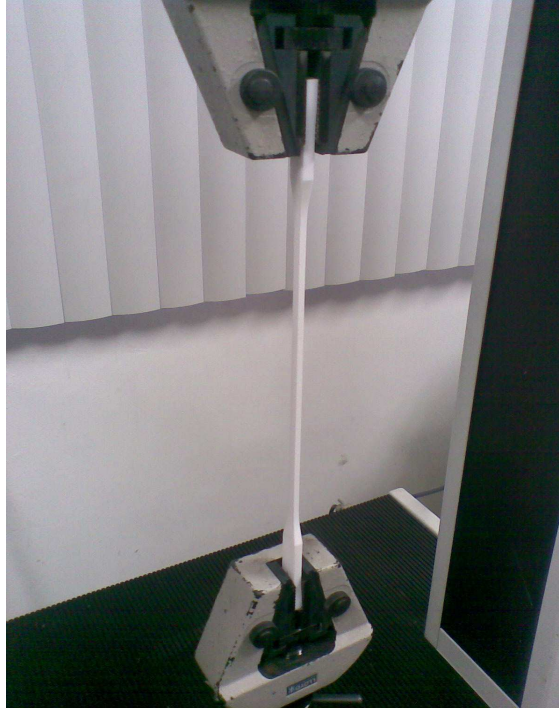
Anexo 6 Alargamiento de la probeta durante el ensayo
