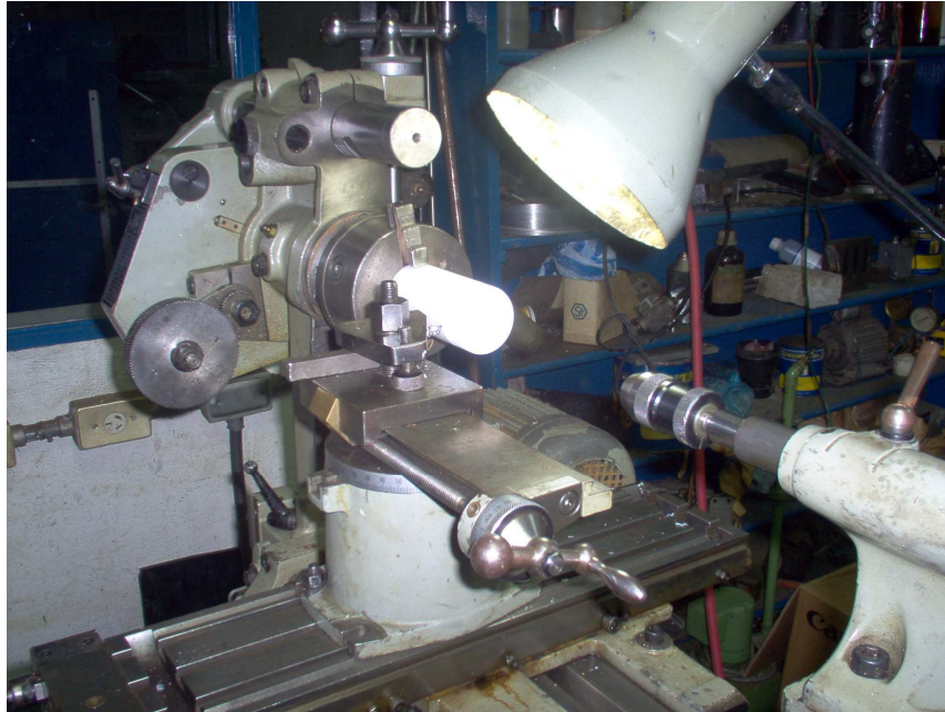
Anexo 8 Construcción del vaso del recipiente
