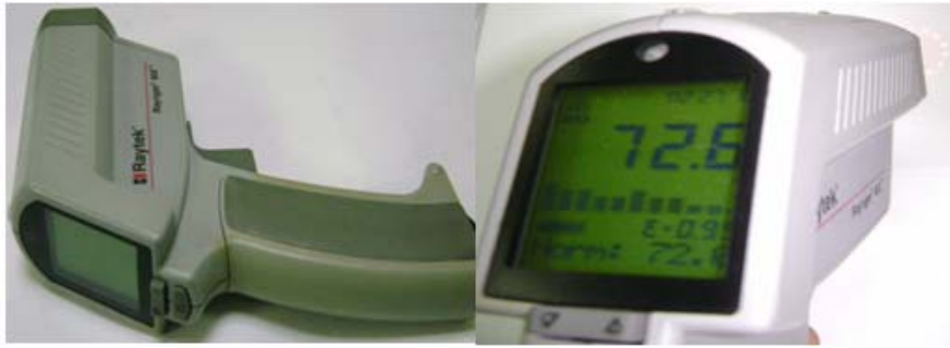
Figura N°3.9. Equipo láser medidor de temperaturas de superficies (Elaboración Propia).
