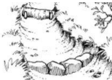
Figura 93: Dique para contención de sedimentos en senderos erosionados
