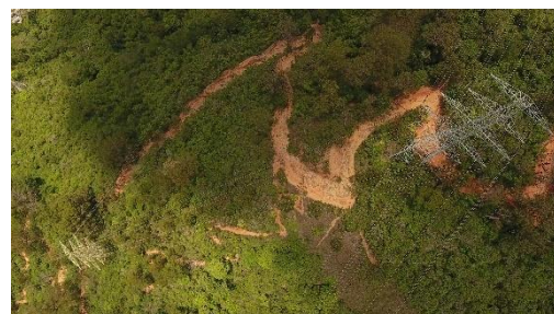
Figura 18: Vista aérea de la erosión en el sendero “Sabas Nieves I” - “Sabas Nieves II”
