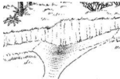
Figura 94: Canales de drenaje superficiales en senderos escarpados
