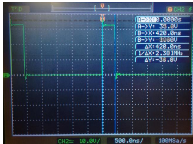
Figura 5.3.14: Tiempo entre flanco de subida y bajada de la señales SLOE y SLRD.
