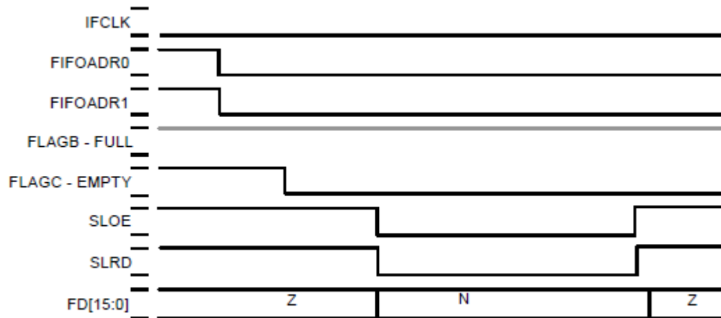
Figura 4.3.21: Diagrama de tiempos: lectura de datos en el FIFO esclavo.
