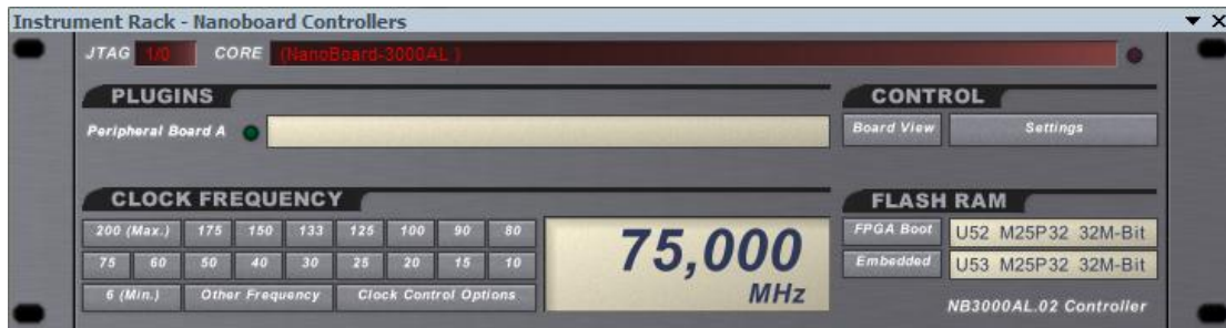
Figura 5.3.8: Instrumento controlador de frecuencia.
