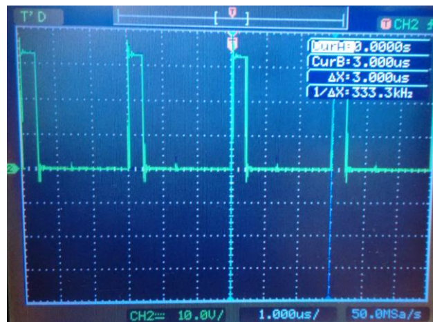
Figura 5.3.13: Tiempo entre flancos de subida de la señales SLOE y SLRD.
