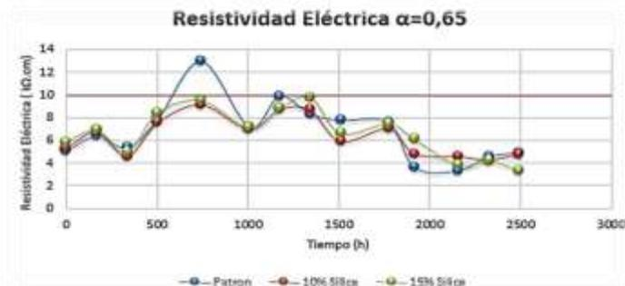
Figura 11. Comportamiento de probetas con relación agua-cemento de 0,65.
