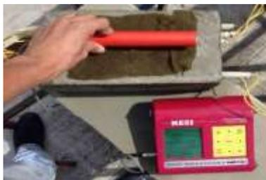
Figura 4 Medición de la resistividad eléctrica.
