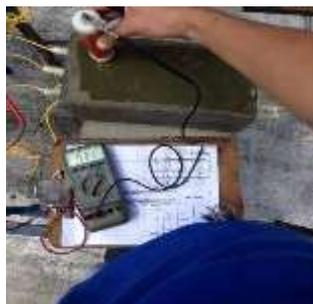
Figura 2. Medición del potencial eléctrico.
