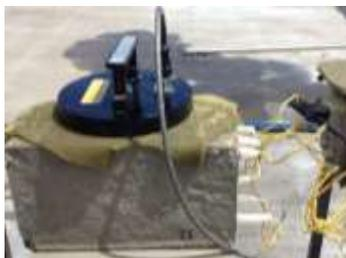
Figura 3. Medición de velocidad de corrosión con GECOR 6.
