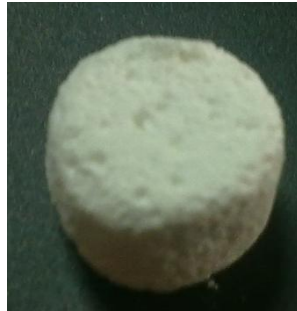
Figura 19. Espuma cerámica compuesta de alfa-alúmina.
