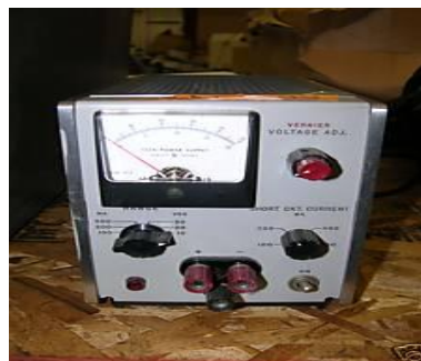
Figura 10. Fuente de poder: Hewlett Packard 723A ubicada en el laboratorio de tratamiento de metales en la escuela de Mecánica, Facultad de Ingeniería de la Universidad Central de Venezuela.
