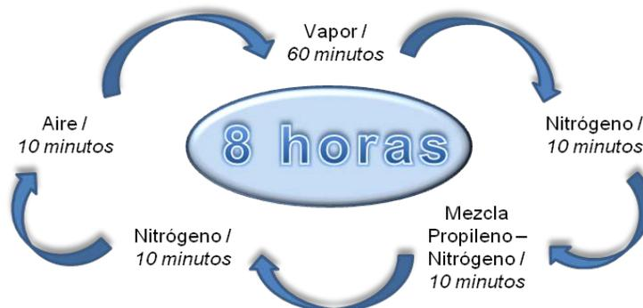
Figura N° 4.2. Procedimientos de CPS.
