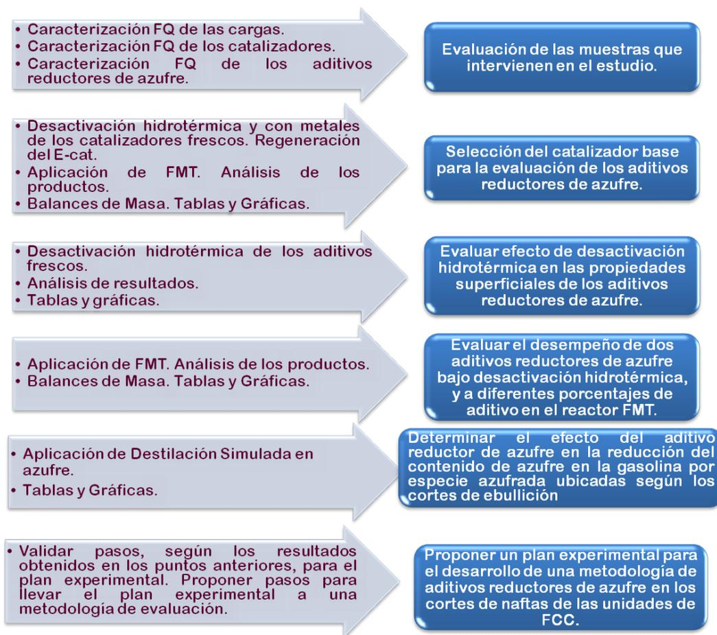
Figura N° 4.1. Esquema general del procedimiento experimental.
