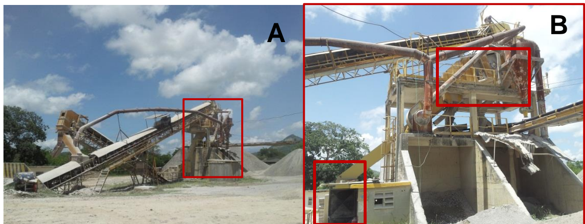
Figura 5.4 – A) Circuito II B) Criba vibratoria agregados y trituradora de mandíbula
