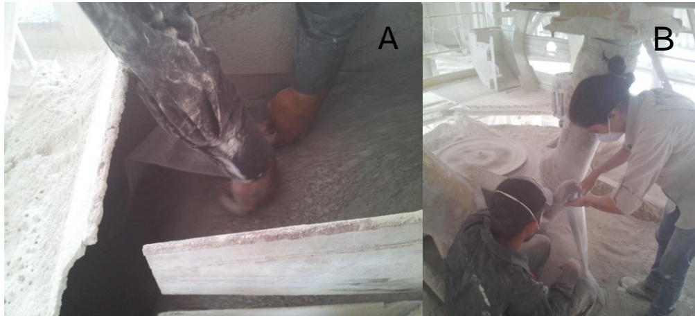
Figura 4.3 – Toma de muestra en los silos. A) Descarga del silo. B) Alimentación al separador isodrómico. Fuente Propia
