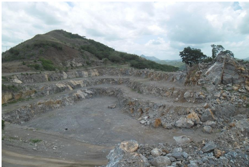
Figura 2.3 – Frente de Explotación de la Cantera Agua Viva II, método de terracedo a cielo abierto. Fuente ARAMICA
