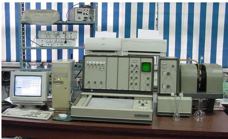
**Figura N° 21.** Equipo de Resonancia Paramagnética Electrónica (RPE).
