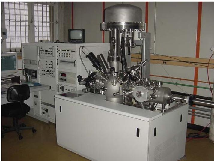
**Figura N° 22.** Espectrómetro Fotoelectrónico de Rayos-X (XPS).
