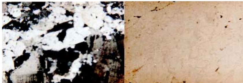
Fig. 10 Fotomicrografía. Objetivo 4/0.12. NX : N//. Muestra # 4. Gneis Cuarzo-plagioclásico-muscovítico. Obsérvese el aspecto masivo.
