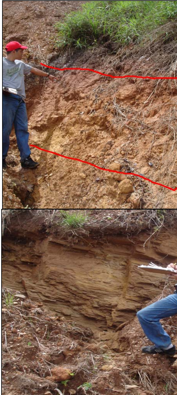
Figura 48: Perfil de Meteorización de la Unidad Esquisto Cuarzo Moscovítico- Azimut 60°
