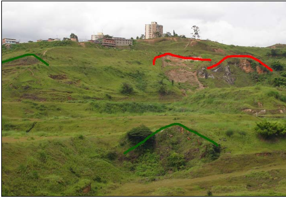
Figura 51: Deslizamiento Rotacionales activos (rojo) como antiguos (verde) en la UEQM. Cerca de Encantado Azimut 70^\circ
