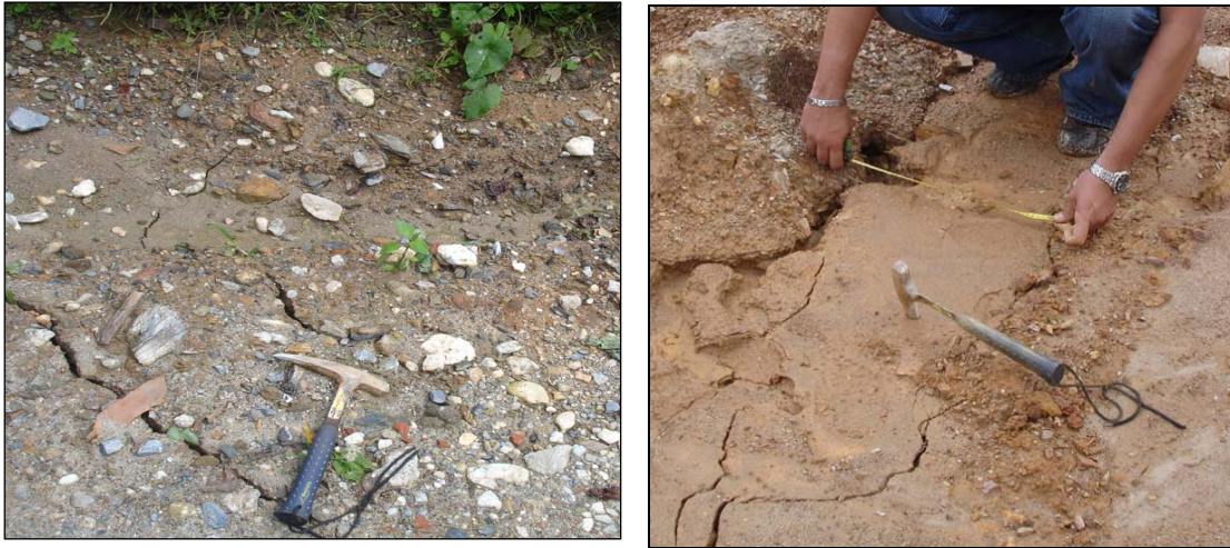
Figura 55: Grietas de deslizamiento en la Unidad de Esquistos Cuarzo Moscovíticos-UEQM – Azimut 60°
