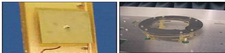
Figura 3. (a) Radiador Rectangular (b) Radiador de Anillo Circular.
