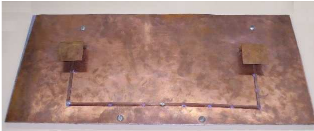
Figura 33. Montaje Experimental del Arreglo de 2 elementos PIFA.
