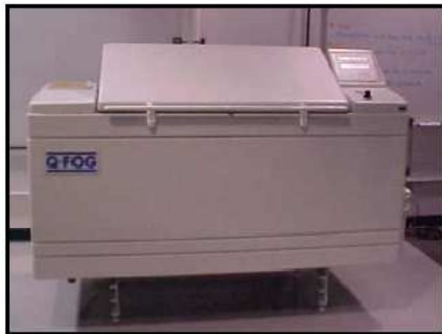
Figura 22. Cámara para Exposición a la Salitre.
