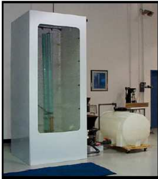
Figura 21. Cámara para Exposición a la Lluvia.
