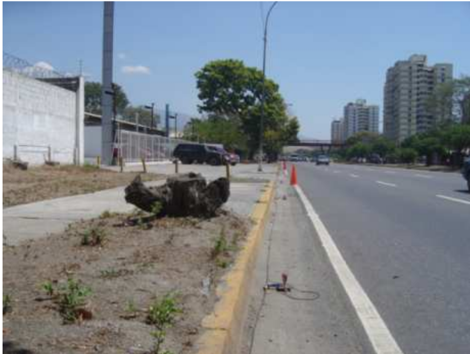
Figura V-4. Segmento del tendido de adquisición ReMi (estación Guarenas 1, Cortesía de TRX Consulting).
