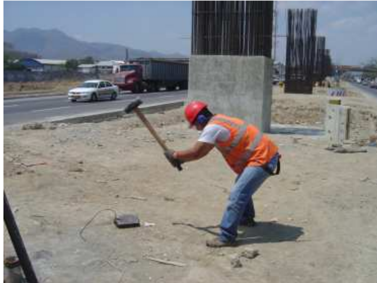
Figura V-8. Impactos de mandarria para generar ondas P (Cortesía de TRX Consulting).
