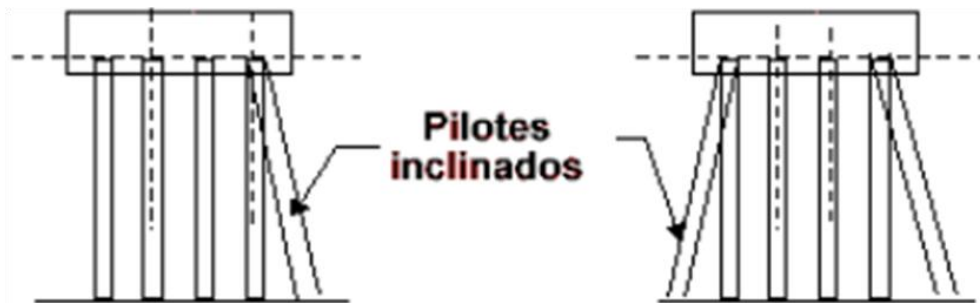
Figura N° 2.14 – Combinación de pilotes verticales e inclinados Referencia: www.construaprende.com/t/03/t3pag2.php
