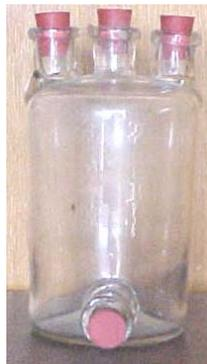
**Figura 25. Recipiente de condensado.**
