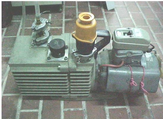
**Figura 29. Bomba Eléctrica 220 Vol.**
