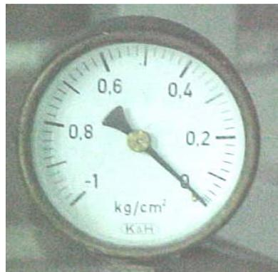
**Figura 20. Manómetro de vacío.**
